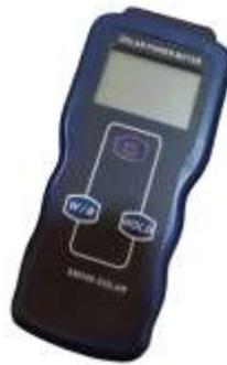
Figure (4.4): Solar Power Meter (SM206).
