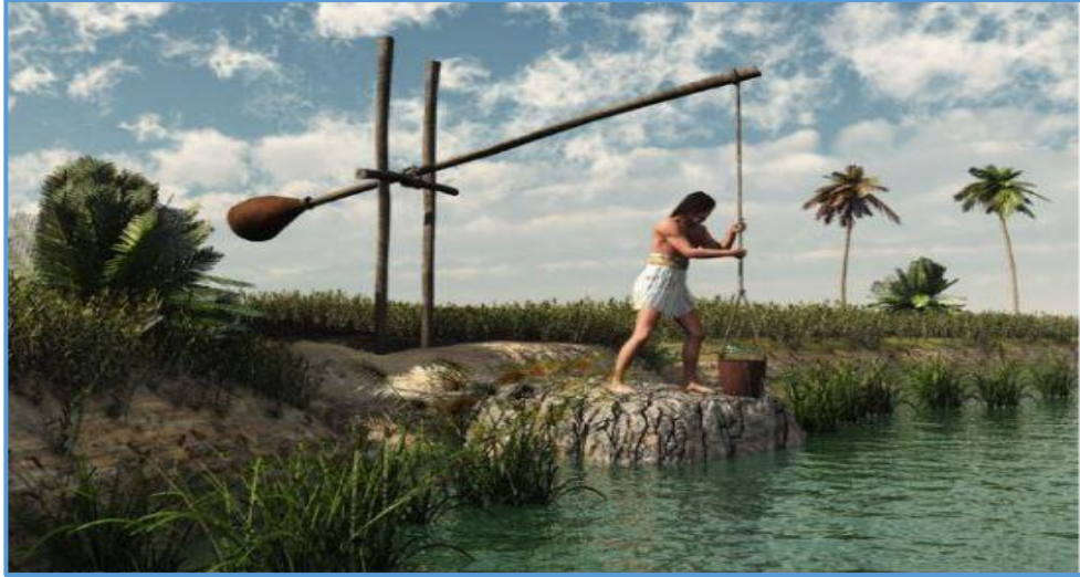
الشكل (1-1): الشادوف (المنزفة) المستخدم لرفع مياه الري من الاماكن المنخفضة 2 .
