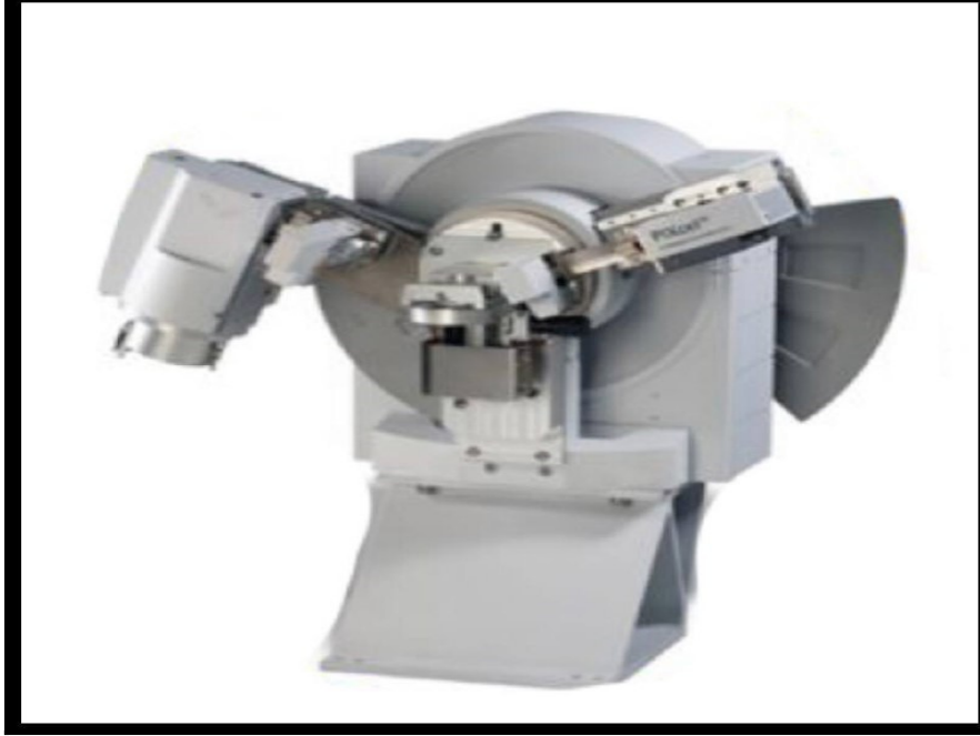
الشكل (3)-(5) جهاز XRD المستخدم في الفحص
