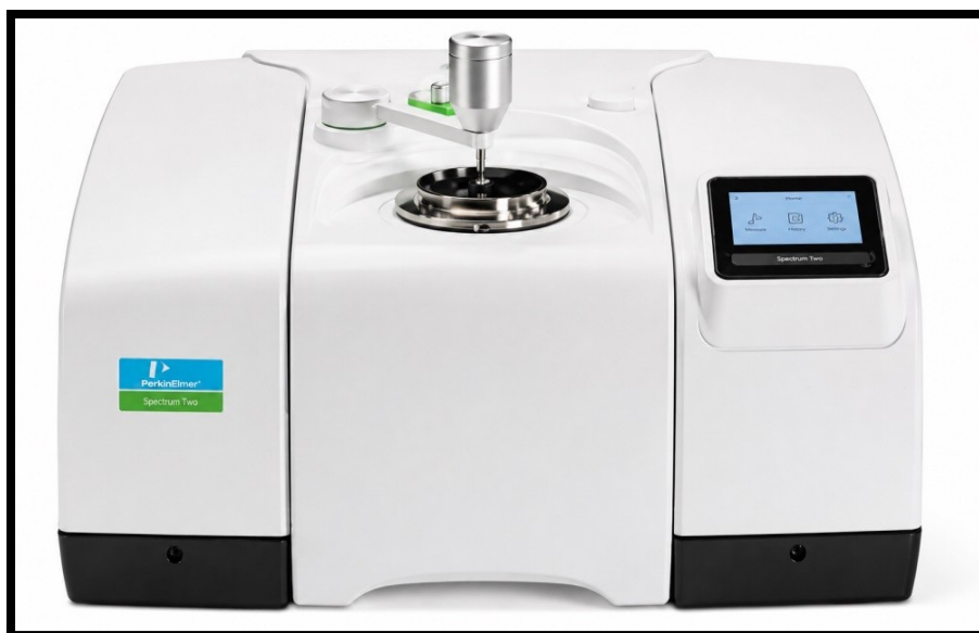
الشكل (3-13) جهاز FTIR المستخدم في الفحص
