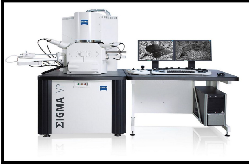
الشكل (7-3) جهاز FE-SEM المستخدم في الفحص
