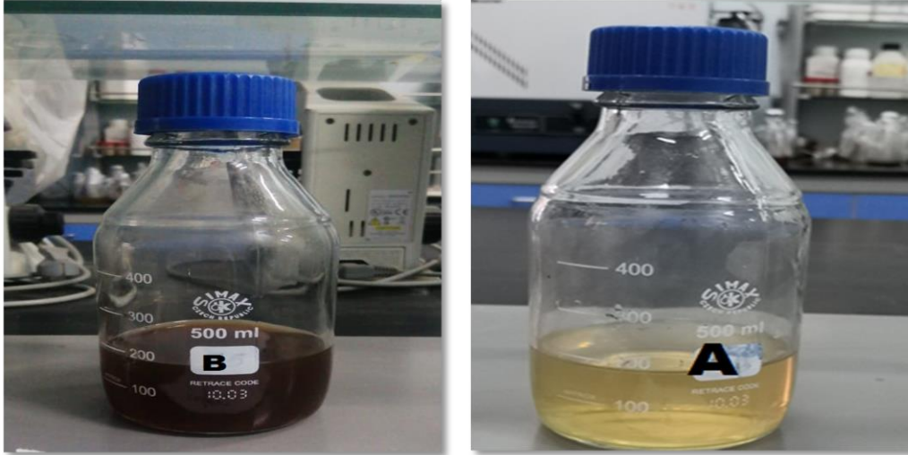
شكل (17) التغير اللوني لراشح مزرعة الفطر A. tubingensis A. راشح المزرعة غير المعامل ب AgNO_3 B. راشح المزرعة الحاوي على AgNO_3 72 ساعة من الحضانة
