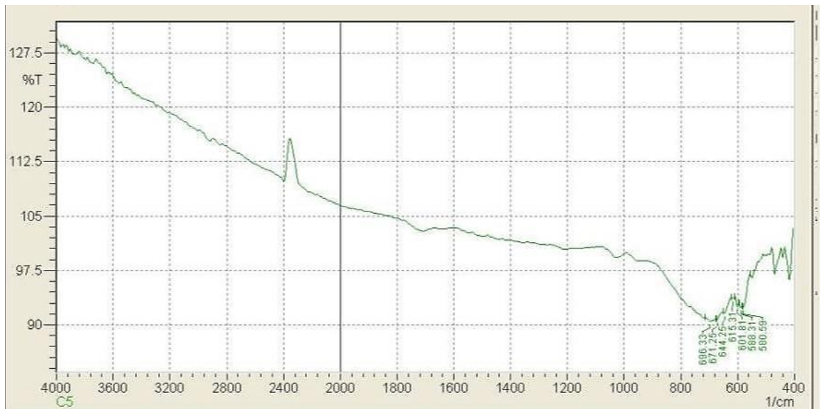
الشكل (9.3) طيف FT-IR للمترابك النانوي C 5
