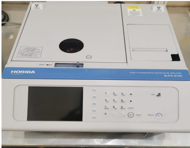
شكل (5.2) صورة لجهاز قياس نسبة الكبريت في النفط X-ray fluorescence Sulfur in oil analyzer
