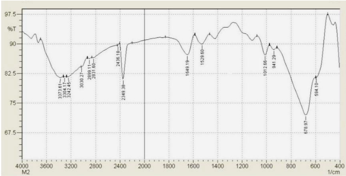
الشكل (3.3) طيف FT-IR للمركب TiO_2 النانوي
