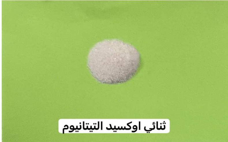
شكل (2.2) صورة توضح الناتج النهائي لثنائي اوكسيد التيتانيوم المحضر.
