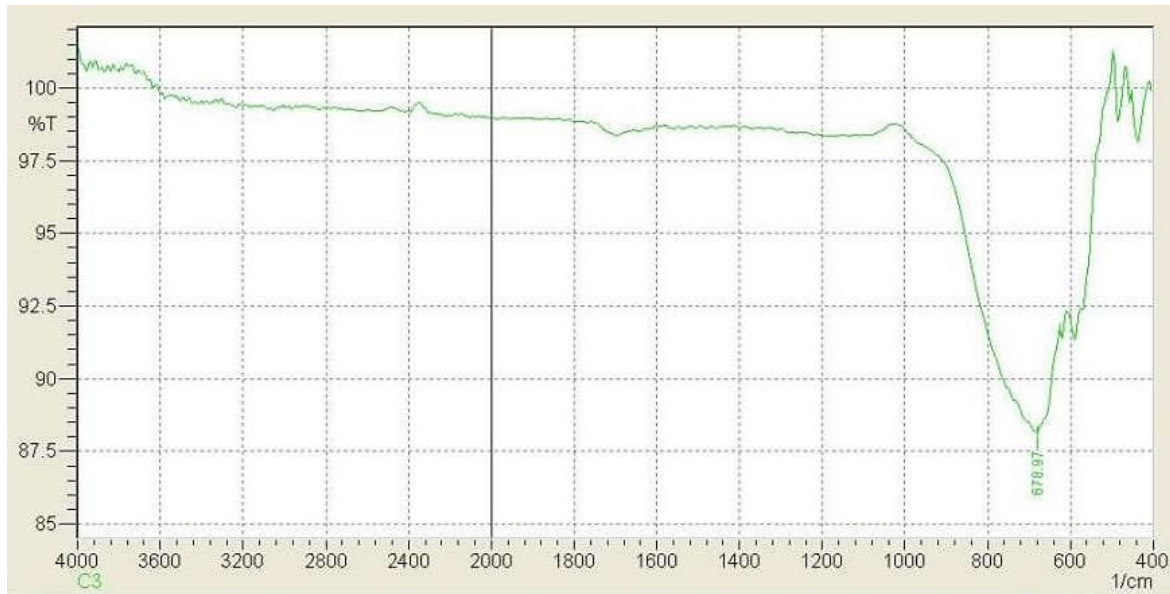
الشكل (7.3) طيف FT-IR للمترابك النانوي C 3
