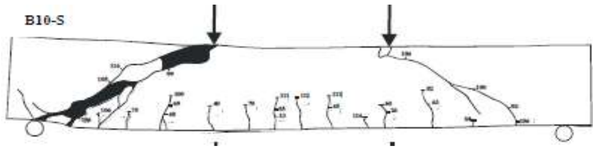
(d) experimental failure
