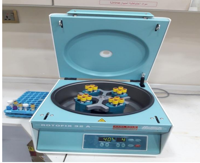
شكل (٣) يوضح جهاز الطرد المركزي المستخدم في فصل مكونات عينة الدم
