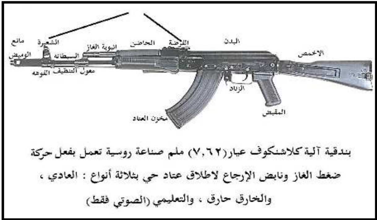
شكل (2) يوضح صورة تفاصيل البندقية الكلاشنكوف (AK 47)
