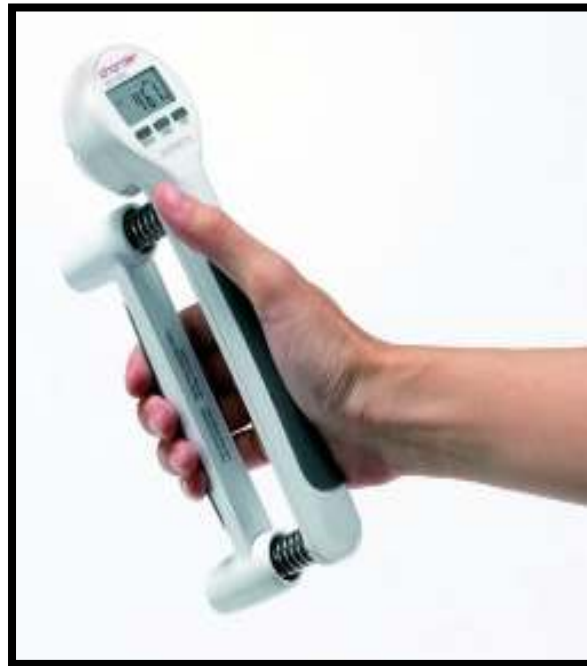
شكل (8) يوضح جهاز المانوميتر الإلكتروني
