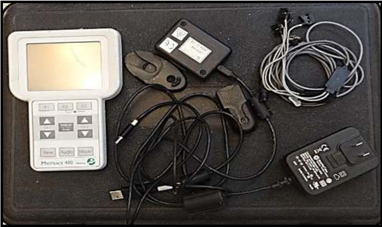
شكل (6) يوضح منظومة جهاز (EMG) نوع (Myo trace 400) بمرسل الـ (Bluetooth)
