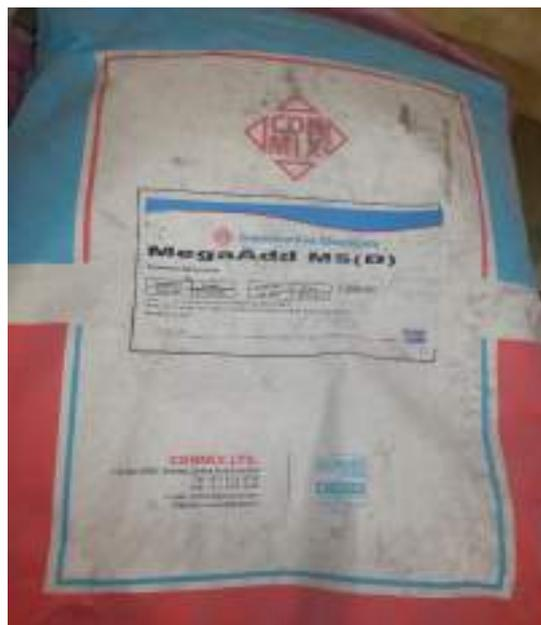
Fig. 3-2 Micro-silica (silica fume).
