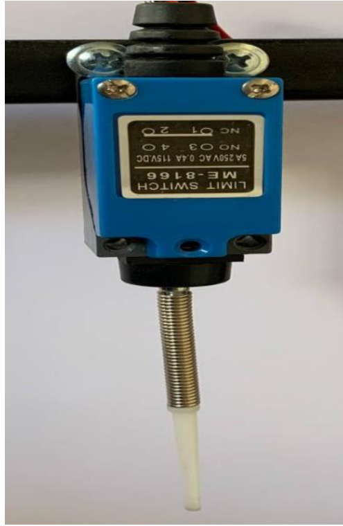
الشكل (4) يوضح مفتاح نهاية الشوط (Limit switch)
