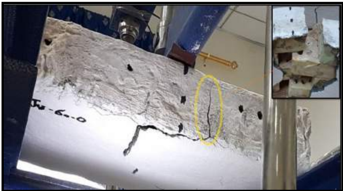
(d) Mode of failure for Jv-60-0 specimen.
