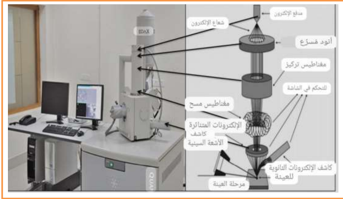
الشكل (3-4) جهاز المجهر الإلكتروني الماسح SEM [210].
