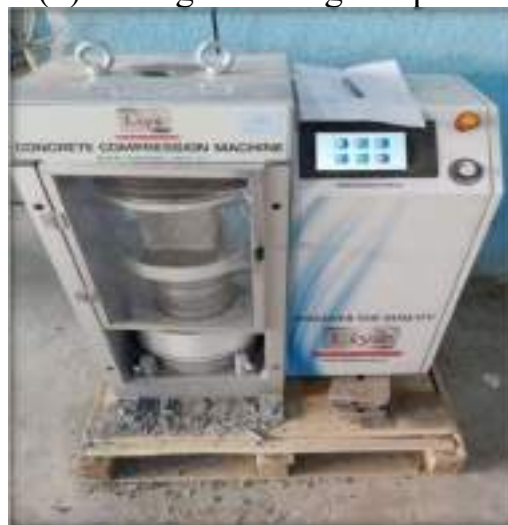
(d) Testing of cube samples.
