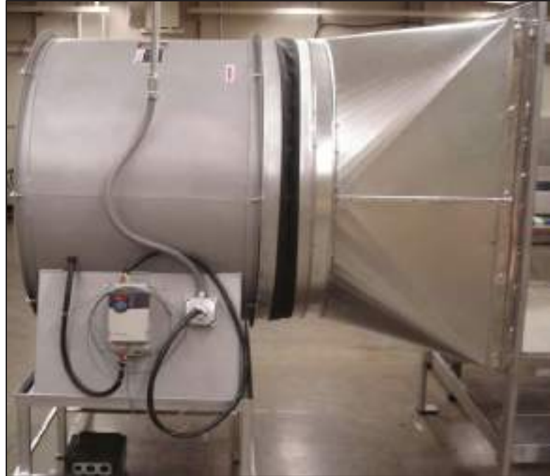
Figure 4.2 Axial Fan (Cincinnati Fan –Size 48, 10 hp)
