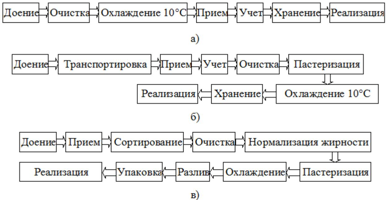
Рисунок 1.1 – Схемы линий получения и обработки молока
