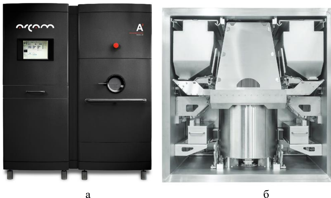
Рис. 2.4. Установка электронно-лучевого плавления Arcam A2 а-внешний вид установки; б-устройство вакуумной камеры
