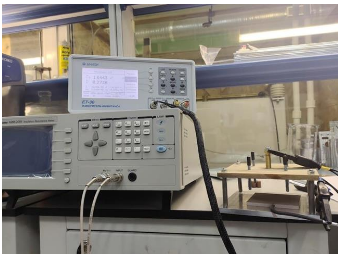
Рис. 3.17. Подключение E7-30 к измерительной ячейке.
