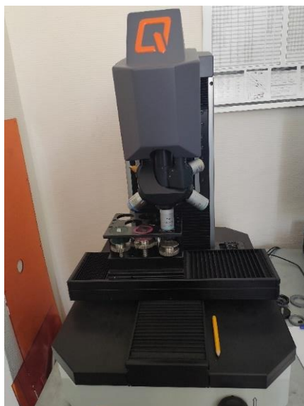
Рис. 2.12. Микротвердомер QNESS Q10A
