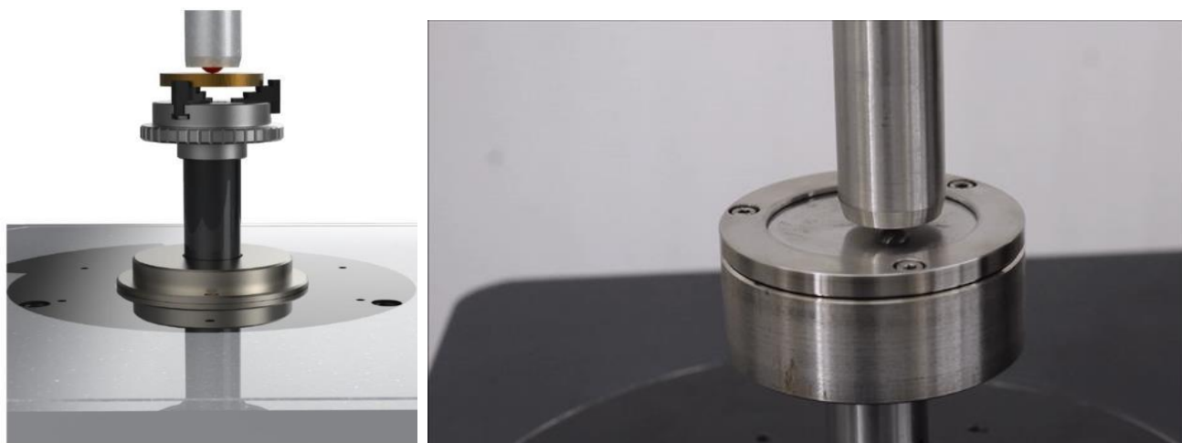
Рис.2.16. Узел трения DUCOM POD-4.0
