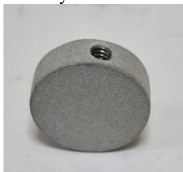
Иллюстрация на Рис. 3.2 демонстрирует образцы из титанового сплава Ti6Al4V после процесса ПЭО, предназначенные для исследований.
