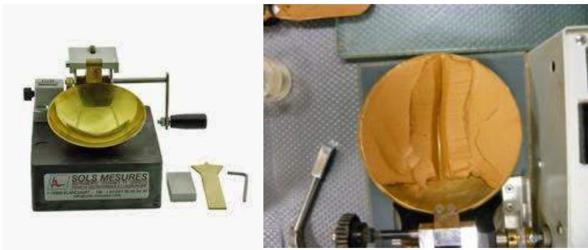
Fig.II.2 Le dispositif utilisé pour mesurer la limite de liquidité.
