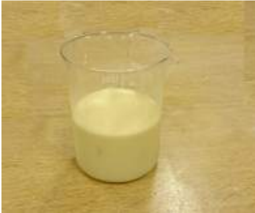
a- Le Kaolin et le mélange d'eau distillée et d'un défloculant
