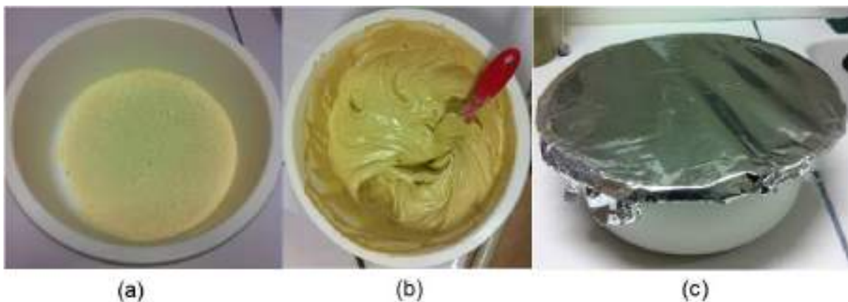
Fig.III.2 Préparation de la boue, (a) Poudre de kaolin, (b) La boue de kaolin, (c) La boue de kaolin dans une bassine et protégée par un film plastique et du papier aluminium.
