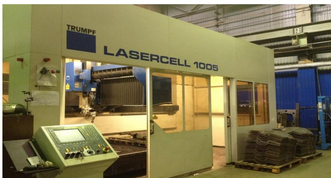
Рис. 2.1.1 Многофункциональный лазерный технологический комплекс для объемной лазерной обработки TrumfLasercell 1005, мощность – 5 кВт (CO<sub>2</sub>)
