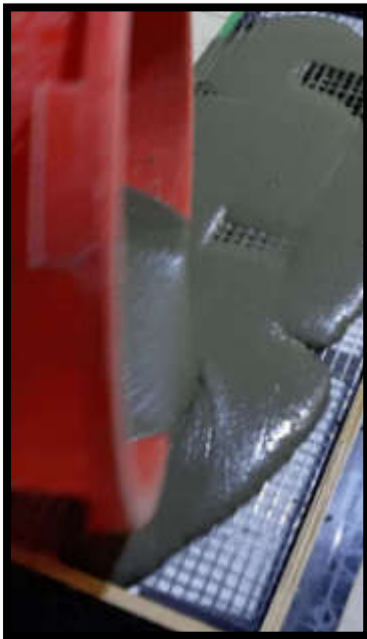
(d) Apply mortar.
