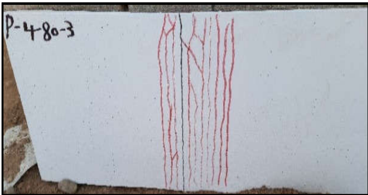
(d) Mode of failure for P-4-80-3 specimen.
