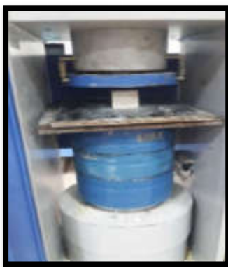
(d) Compressive strength test.
